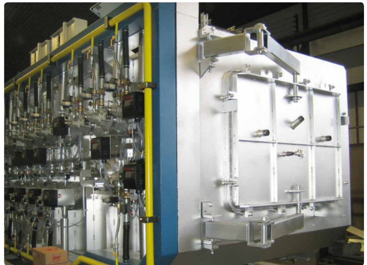
Härteofen, hintere Stirnseite mit Montage- und Wartungstür nächst Fallschacht in das Abschreckbad
